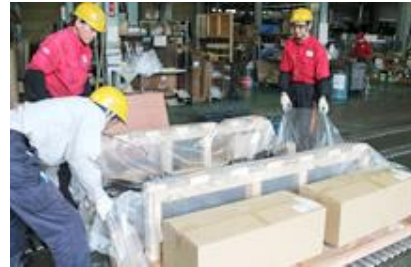
防錆処理を施したシートをかぶせ、クレーンを使って土台に積み付けます。
