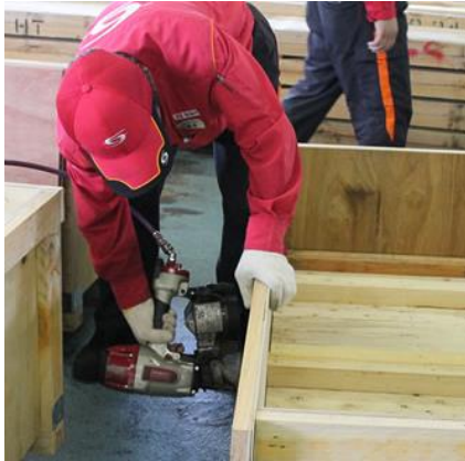
エア釘打ち機で、プシュン！プシュン！とリズムカルに木板を打ち付けていきます。
